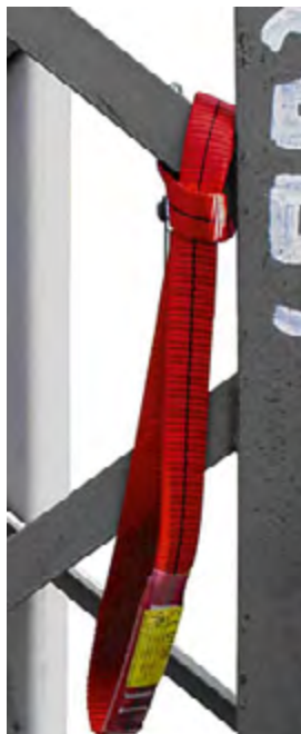
Bild 33: Beispiele für die Verwendung einer Bandschlinge als Anschlaghilfe
