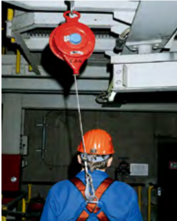
Bild 6: Beispiel eines Auffangsystems mit Höhensicherungsgerät
