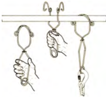
Bild 26: Beispiel für ein Anschlagverbindungselement
